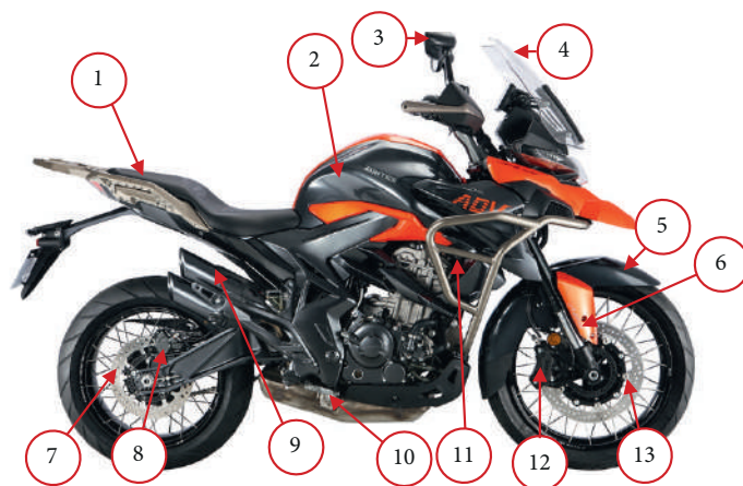
Фото 2.2. Вид справа: 1 – сиденье; 2 – топливный бак; 3 – зеркало заднего вида; 4 – ветровое стекло; 5 – крыло переднего колеса; 6 – защита правого пед; 7 – задний тормозной диск; 8 – задний тормозной суппорт; 9 – глушитель; 10 – педаль заднего тормоза; 11 – катушка зажигания; 12 – передний тормозной суппорт; 13 – передний тормозной диск.
