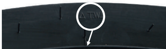
Фото 2.27. Расположение метки износа шины.
