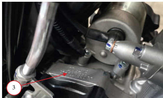
Фото 1.2. Справа на двигателе нанесен серийный номер двигателя - 3.
