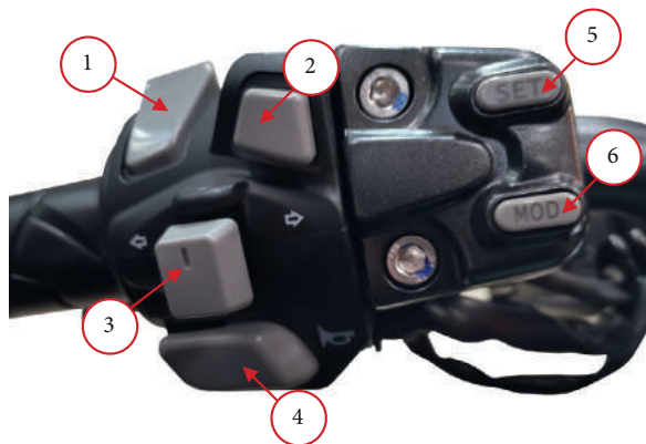
Фото 2.4. Левый блок переключателей: 1 – переключатель режима света фары (дальний/ближний); 2 – кнопка включения аварийной сигнализации; 3 – переключатель поворотов; 4 – кнопка звукового сигнала; 5 – кнопка «SET»; 6 – кнопка «MODE».
