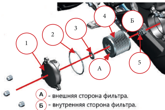
Фото 4.7. Замена масляного фильтра:
