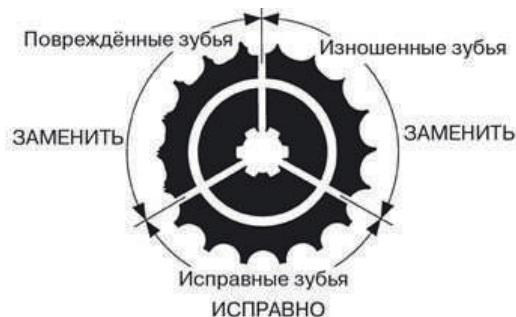
Рисунок 4. Износ звезд.
