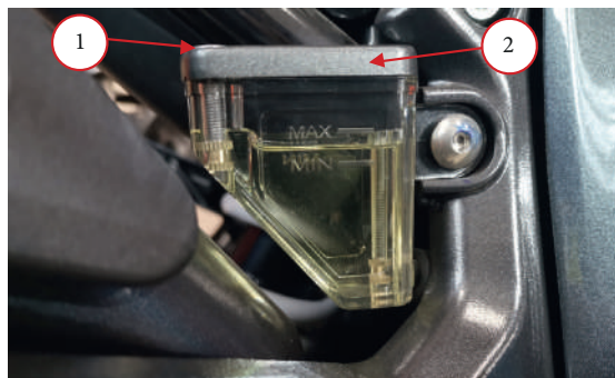
4.9.2. Бачок тормозной жидкости задних тормозов: 1 – винты крепления крышки бачка; 2 – крышка бачка.
