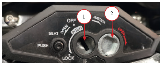
Фото 2.7. Комбинированный замок для модели ZT125-Z2: 1 – замочная скважина; 2 – гнездо поворотной защиты.
