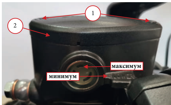
4.9.1. Бачок тормозной жидкости передних тормозов: 1 – винты крепления крышки бачка; 2 – крышка бачка.
