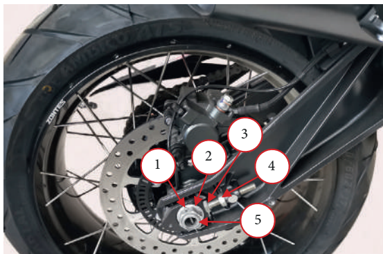
Фото 4.14. Снятие заднего колеса (вариант): 1 – шплинт; 2 – гайка оси колеса; 3 – натяжитель цепи; 4 – стопорная гайка; 5 – ось колеса.
