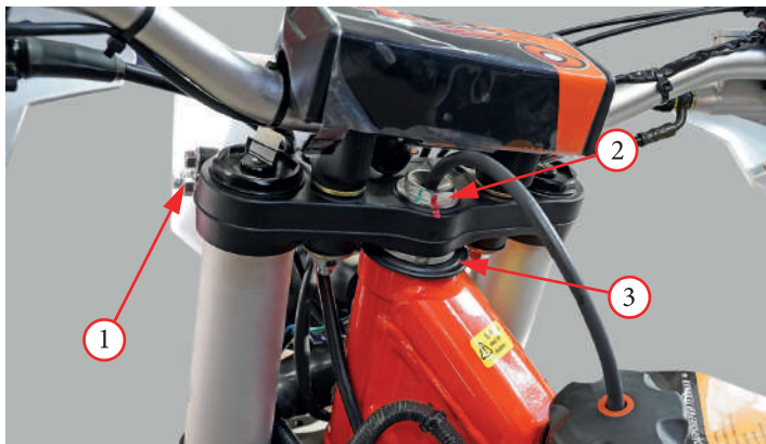
Фото 5.33. Регулировка подшипников рулевой колонки
