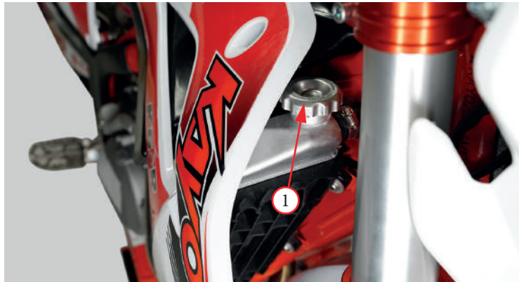
Фото 5.6. Контроль уровня охлаждающей жидкости
