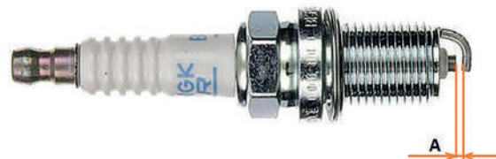
Фото 5.16. Зазор между электродами свечи зажигания
