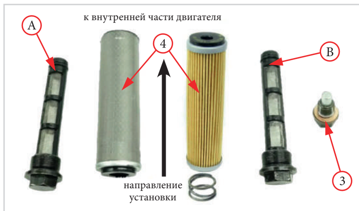
Фото 5.4.1. Замена масла в двигателях с масляным фильтром
