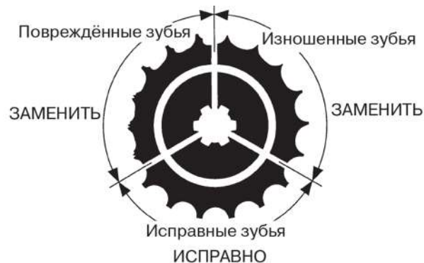
Рисунок 5.27. Вид зубьев звездочки
